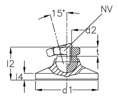
d1 = 50 d2 = 12 l2 = l4 = -NV = 17 Static load (kN) = 30 t min = 11.5
